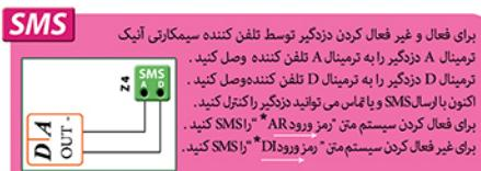
برای فعل و غیر فعل کردن دزدگیر تلفن کننده سیمکارتی آنیک
