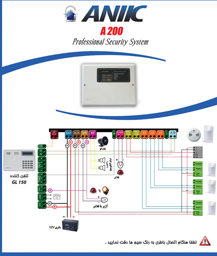
لطفا هنگام اتصال باتری به (ذکر شده) سیم‌ها دقต نمایید.
